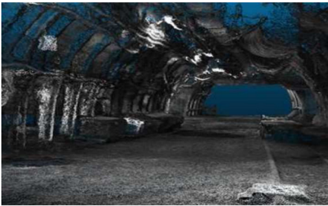
图 5 地下矿井 3 维成像，可备查各处坐标位置和细节
